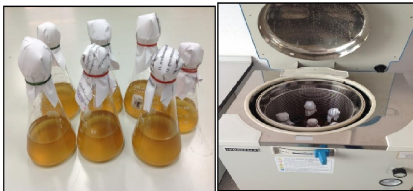
ภาพผนวก 7 การปิดจุกขวดบรรจุอาหาร และการนำอาหารเลี้ยงเชื้อไปทำให้ปราศจากเชื้อโดยการนั่งด้วยหม้ออัดความดัน (autoclave)
