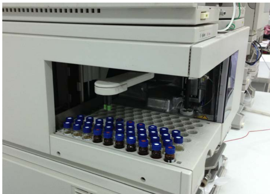
ภาพผนวก 14 การวิเคราะห์หาความเข้มข้นของสารไกลโฟเสทที่เหลื่ออยู่ด้วยเครื่อง High Performance Liquid Chromatography (HPLC) รุ่น Agilent 1100
