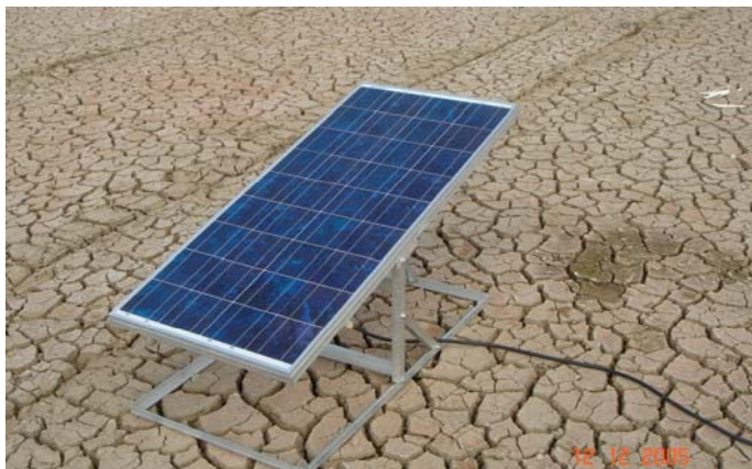
ภาพที่ 26 แผงเซลล์แสงอาทิตย์ชนิดคริสตัลไลน์ซิลิคอน (Crystalline Silicon)
