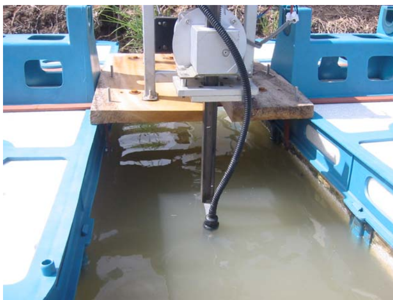
ภาพที่ 29 เครื่องมือขณะทำการวัดค่าออกซิเจน
