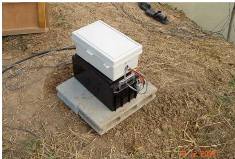
ภาพที่ 28 แบตเตอรี่พร้อมกล่องควบคุมการประจุแบตเตอรี่
