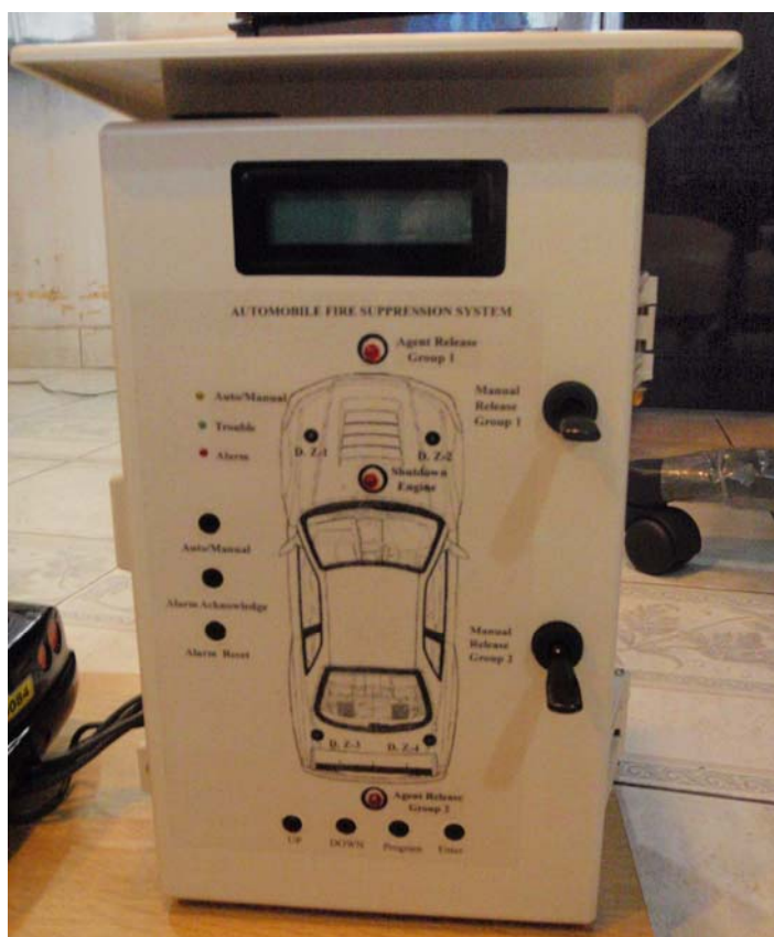
ภาพที่ 19 แสดงชุดปั๊มควบคุมพร้อมส่วนแสดงผลจอ LCD และหลอดไฟ LED
