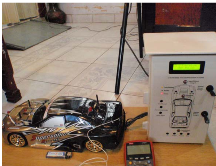
ภาพที่ 42 แสดงระบบหยุดการสั่งตัดการทำงานของเครื่องยนต์ พร้อมหยุดระบบสั่งฉีดสารดับเพลิง
