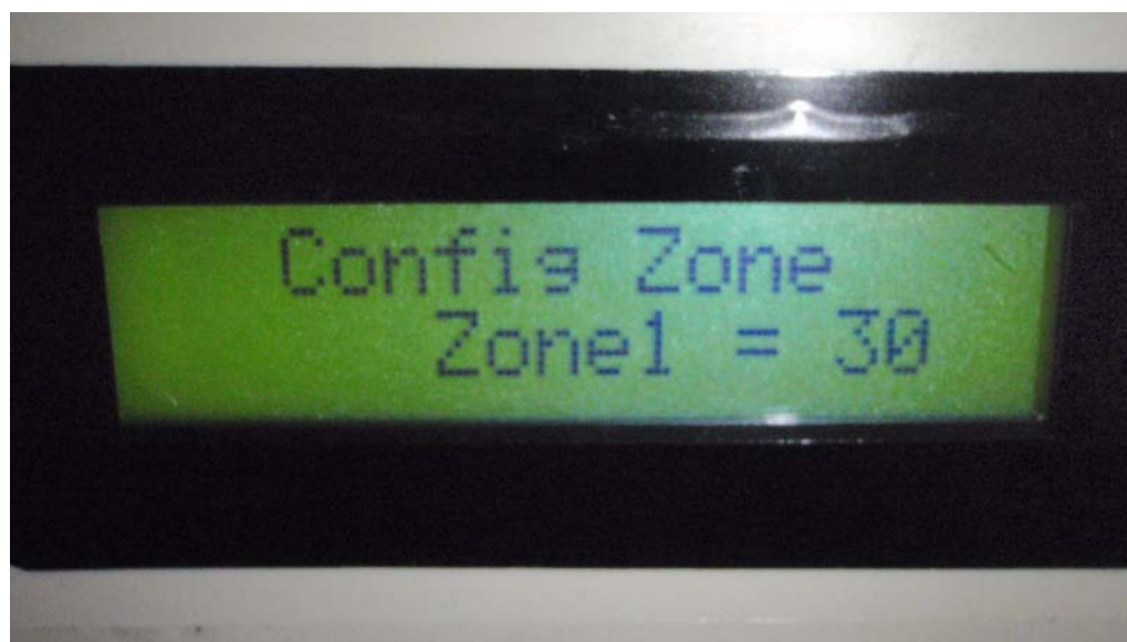
ภาพที่ 29 เมื่อทำการป้อนค่าอุณหภูมิที่ต้องการให้อุปกรณ์ทำการแจ้งเตือนตำแหน่งที่ 1
