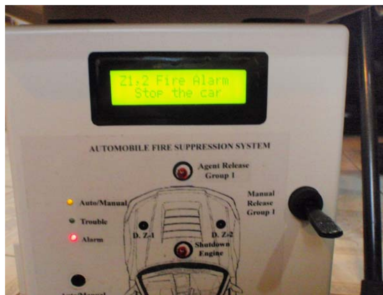
ภาพที่ 41 แสดงตัววัดอุณหภูมิในตำแหน่งที่ 1 และ 2 ทำงานพร้อมไฟ Auto/Manual ติด หลังกดสวิทช์
