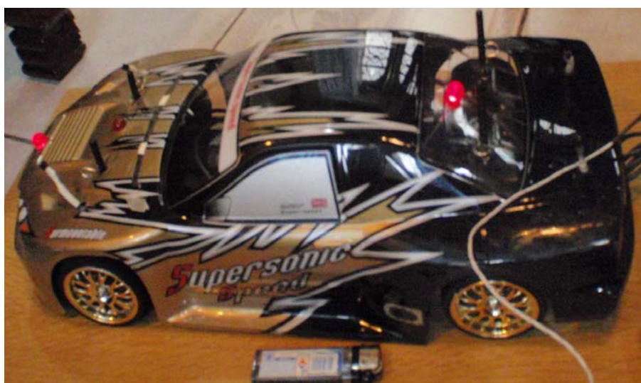
ภาพที่ 45 ไฟ LED แสดงการส่งนิตสารดับเพลิงในพื้นที่ห้องเครื่องยนต์และห้องเก็บสัมภาระของ โมเดลดังกล่าวสวิตซ์ Manual Release Zone1 และ 2
