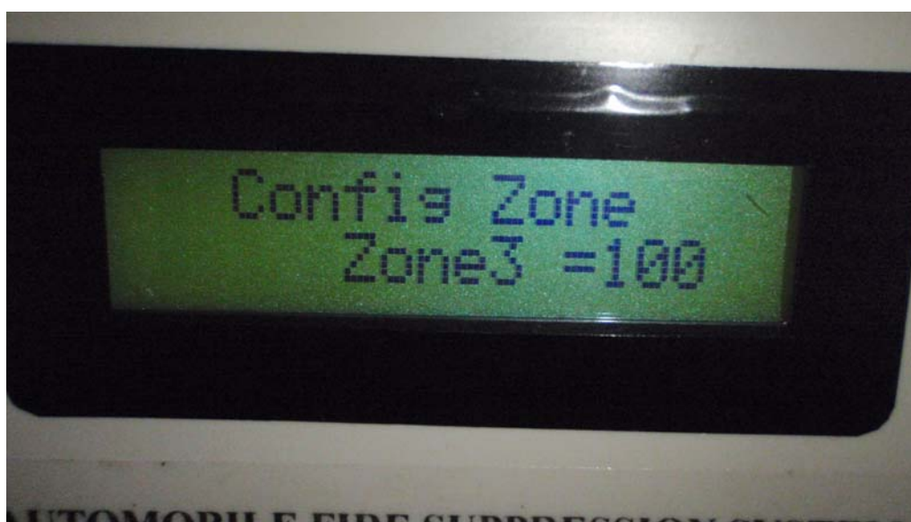
ภาพที่ 31 เมื่อทำการป้อนค่าอุณหภูมิที่ 100°C ให้อุปกรณ์ทำการแจ้งเตือนตำแหน่งที่ 3
