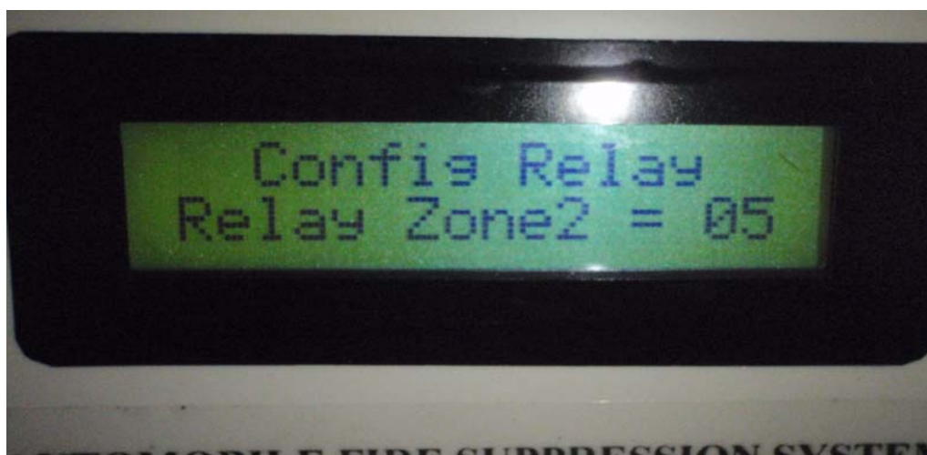
ภาพที่ 33 เมื่อทำการป้อนค่าหน่วยเวลาการสั่งตัดการทำงานของเครื่องย่นต์ 5 วินาทีให้กับพื้นที่การสั่งฉีดที่ 2 ซึ่งกำหนดให้เป็นภายในห้องเก็บสำภาระท้ายรถ
