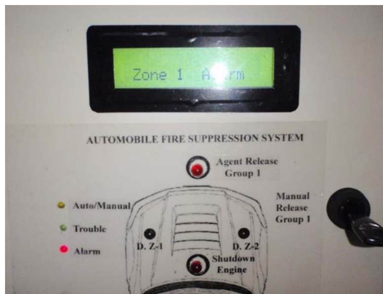
ภาพที่ 40 แสดงการทดสอบตัววัดอุณหภูมิในตำแหน่งที่ 1 พร้อมแสดงสถานะ Alarm
