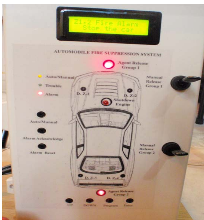
ภาพที่ 44 แสดงการส่งนิตสารดับเพลิงในพื้นที่ห้องเครื่องยนต์โดยสวิตซ์ Manual Release Zone1 และ 2
