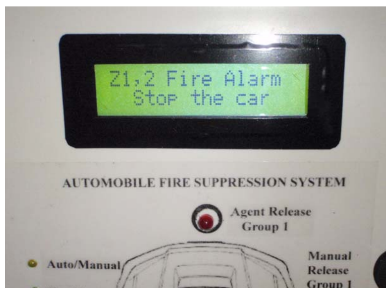
ภาพที่ 37 แสดงการทดสอบตัววัดอุณหภูมิในตำแหน่งที่ 1 และ 2 พร้อมไฟสั่งตัดการทำงานของเครื่องยนต์
