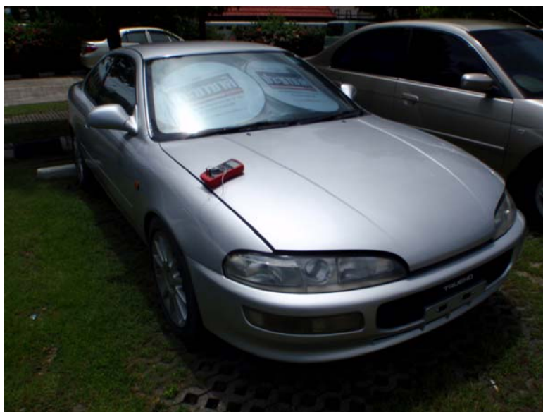
ภาพที่ 26 แสดงทำการปิดฝากระโปรงทิ้งไว้ประมาณ 20 นาที แล้ววัดอุณหภูมิ
