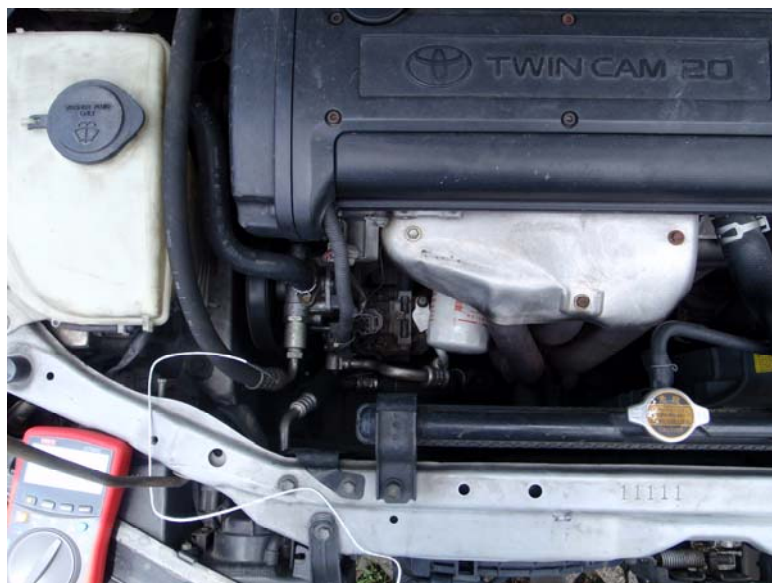
ภาพที่ 25 แสดงการวางตำแหน่งเครื่องวัดอุณหภูมิในตำแหน่งบริเวณท่อไอเสีย
