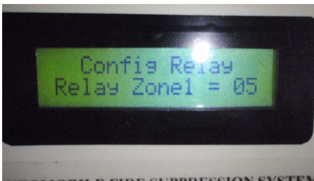
ภาพที่ 32 เมื่อทำการป้อนค่านวเวลาการสั่งตัดการทำงานของเครื่องยนต์สำหรับพื้นที่การเสี่ยง 1 ซึ่งกำหนดให้เป็นภายในห้องเครื่องยนต์
