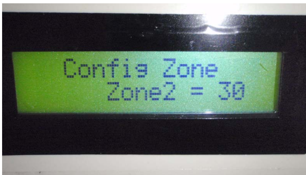
ภาพที่ 30 เมื่อทำการกดปุ่มป้อนค่าโปรแกรม (Enter Button) ในตำแหน่งที่ 1 หน้าจอจะปรากฏให้ป้อนค่าอุณหภูมิที่ต้องการให้อุปกรณ์ทำการแจ้งเตือนตำแหน่งที่ 2 แล้วทำซ้ำจนครบทั้ง 4 ตำแหน่ง โดยสามารถตั้งค่าอุณหภูมิช่วงใช้งานได้ตั้งแต่ 10°C ถึง 120°C
