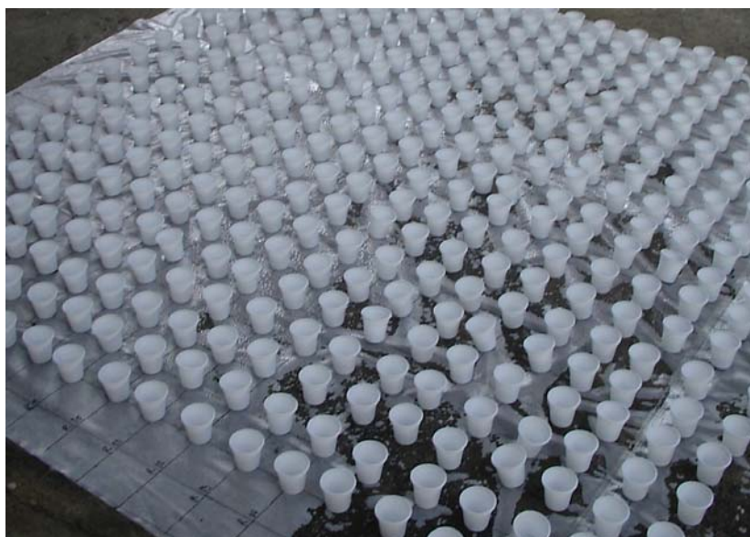
ภาพผนวกที่ ก2 การวางแก้วสำหรับวัดปริมาณน้ำในการทดลองความสม่ำเสมอของละอองน้ำ โดยมีระยะห่าง 10 ซม. จำนวน 200 ใบ
