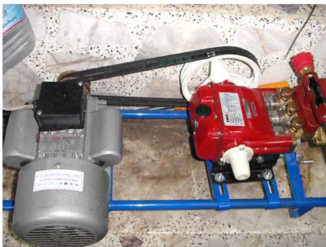
ภาพที่ 18 ปัมสามสูบสำหรับฉีดปุ๋ยในแปลงระบบให้น้ำด้วยสายยางและหัวจ่ายน้ำมินิสปริงเกอร์
