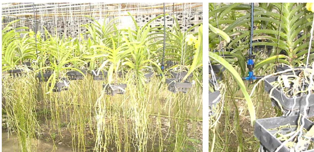
ภาพผนวกที่ ก4 แปลงทดลองความสม่ำเสมอของละอองน้ำกรณีมีต้นไม้ (หัวจ่ายน้ำ DAN สีส้ม)
