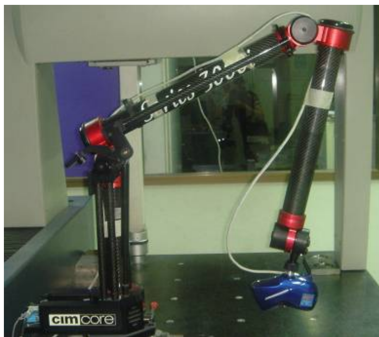
ภาพผนวกที่ 10 แขนกลชิมคอร์พร้อมติดตั้งหัวเลเซอร์ครีออน
