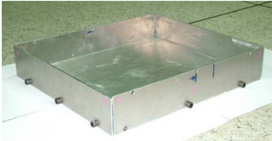
ภาพผนวกที่ 17 ถาดอลูมิเนียม แม่แบบสำหรับแม่พิมพ์ฉีดยาง
