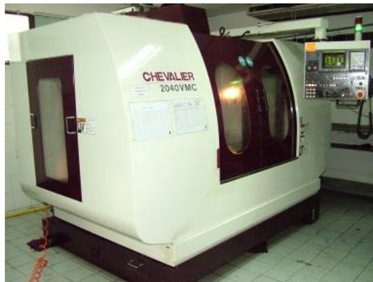
ภาพผนวกที่ 12 เครื่องกัด 3 แกน ชิวาเลีย โมเดล 2040 วีเอ็มซี
