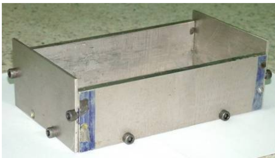
ภาพผนวกที่ 16 กล่องอลูมิเนียม แม่แบบสำหรับแม่พิมพ์ฉีดพลาสติก
