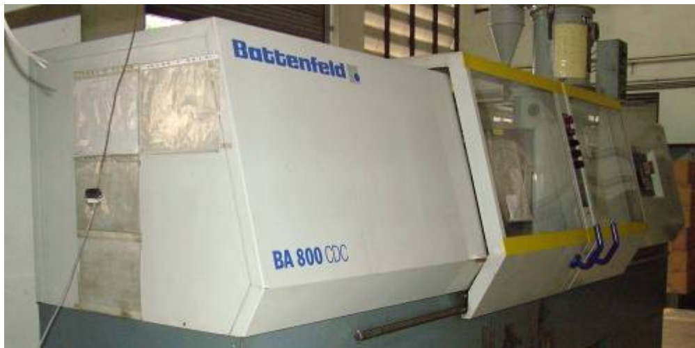
ภาพผนวกที่ 13 เครื่องฉีดพลาสติกแบบเทนฟิลด์
