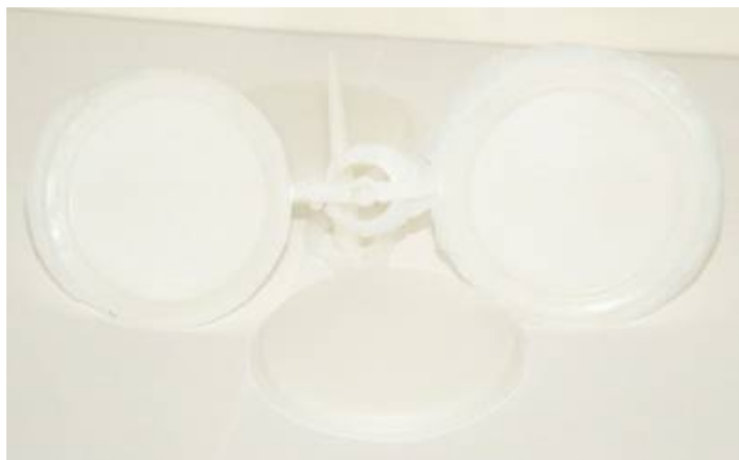
ภาพที่ 134 ชิ้นงานฉีดจากแม่พิมพ์อินเสิร์ตที่หล่อได้โดยใช้เม็ดพลาสติก PS
