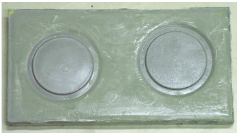
ภาพที่ 116 ผลงานจาก platen เทียนไขกับชิ้นงานพลาสติก PP และ PS โดยใช้อิพอกซีเรซินเดิม อลูมิเนียมเทหล่อหนา 10 มิลลิเมตร เมื่อแกะเทียนไขและชิ้นงานออกแล้ว
