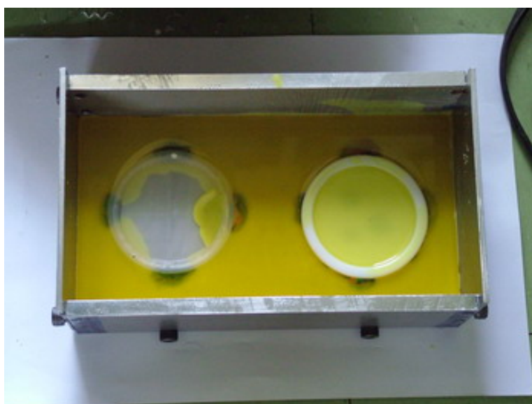
ภาพที่ 113 งาน platen เทียนไขกับชิ้นงานพลาสติก PP และ PS
