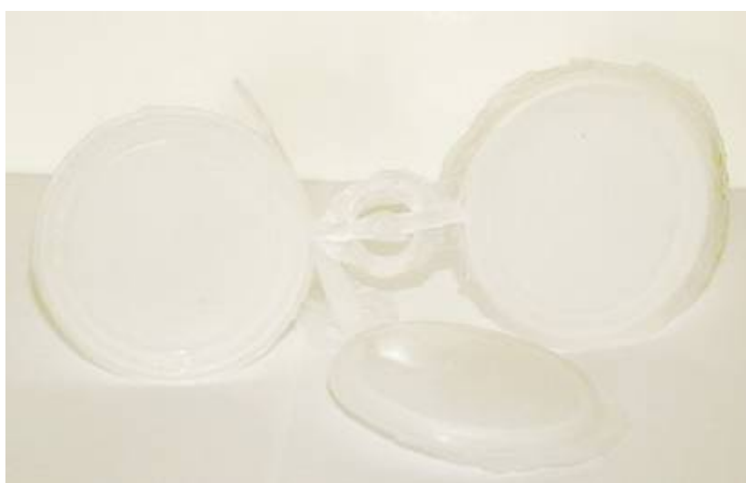
ภาพที่ 133 ชิ้นงานฉีดจากแม่พิมพ์อินเสิร์ตที่หล่อได้โดยใช้เม็ดพลาสติก PP
