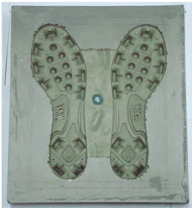
ภาพที่ 125 ชิ้นงานที่เทหล่อเรียบร้อยแล้วด้านคอร์สำหรับชิ้นงานฉีดพื้นยางรองเท้า NIKE
