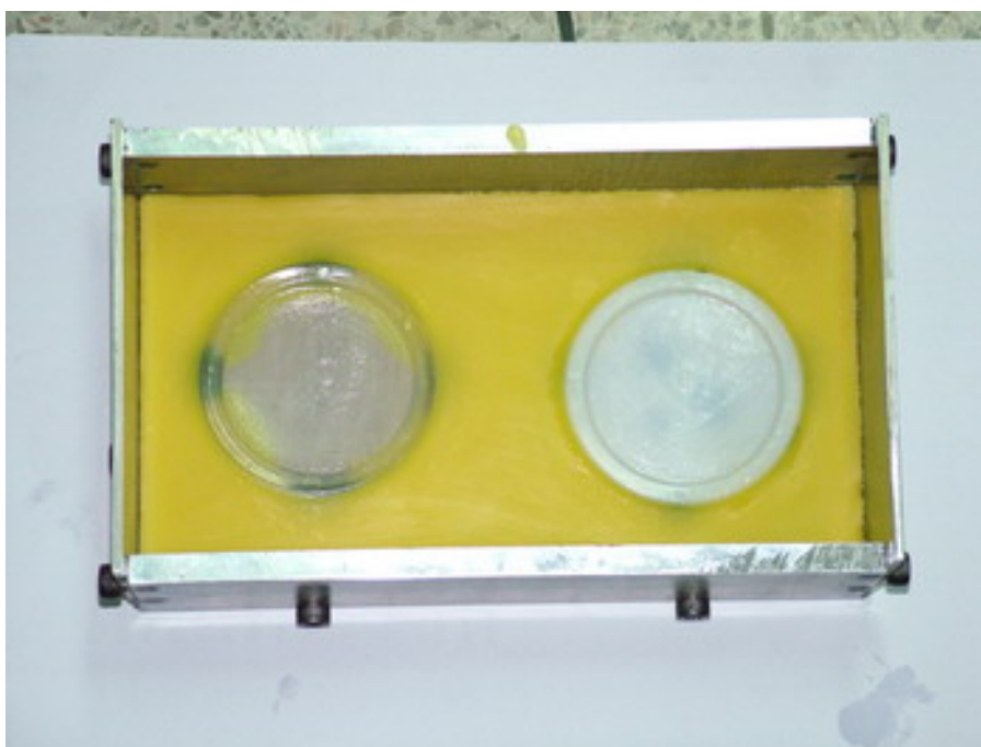
ภาพที่ 114 งาน platen เทียนไขกับชิ้นงานพลาสติก PP และ PS ที่ทำการตกแต่งเก็บรายละเอียด ก่อนเทหล่อเรียบร้อย
