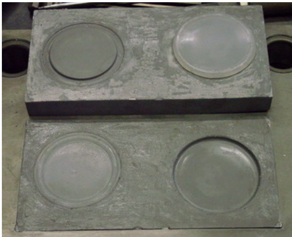
ภาพที่ 124 ชิ้นงานที่เทหล่อเรียบร้อยแล้วด้านควิตีและด้านคอร์สำหรับฉีดชิ้นงานพลาสติก
