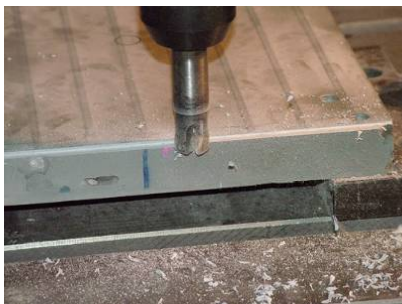
ภาพที่ 127 เก็บรายละเอียดผิวชิ้นงานที่เทหล่ออินเสิร์ตแม่พิมพ์ฉีดยาง
