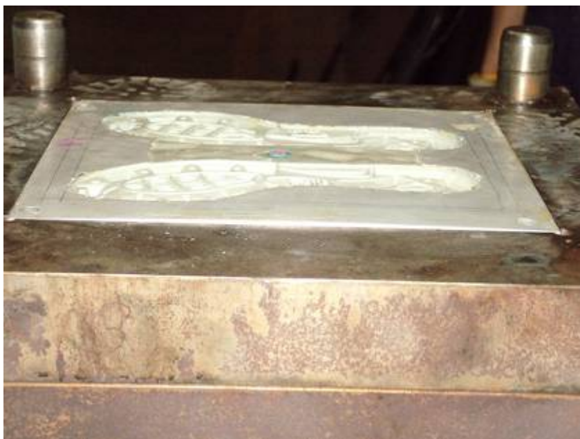
ภาพที่ 137 ชิ้นงานแม่พิมพ์อินเซิร์ตชนิดยางที่หล่อได้หลังการวัดอุณหภูมิเกิดการ โกงงอขึ้น
