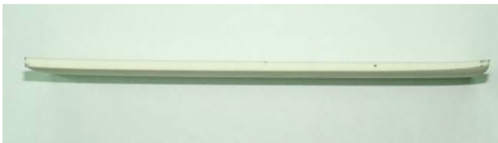
ภาพที่ 139 ชิ้นงานต้นแบบจากเครื่องซินเทอร์สแตชัน ไฮคิวที่เกิดการโค้งงอ
