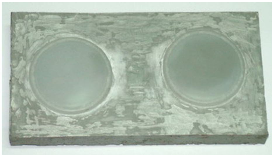
ภาพที่ 120 ผลการเทหล่ออิพอกซีเรซินเติมอลูมิเนียมทับปูนพลาสติก โดยใช้อิพอกซีเรซินเติมอลูมิเนียมเทหล่อหนา 25 มิลลิเมตร เมื่อแกะปูนพลาสติกและชิ้นงานออกแล้ว
