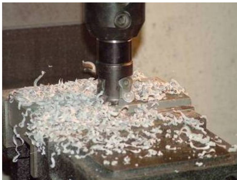
ภาพที่ 126 เก็บรายละเอียดผิวชิ้นงานที่เทหล่ออินเสิร์ตแม่พิมพ์ฉีดพลาสติก
