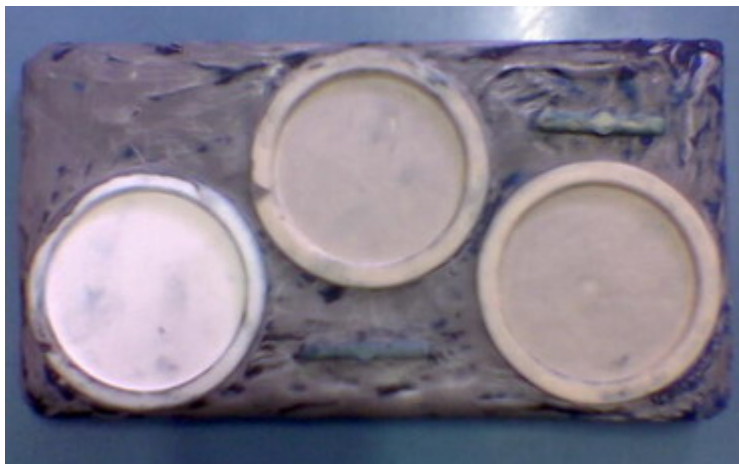
ภาพที่ 108 ผลงานจาก platen ดินน้ำมัน โดยใช้อิพอกซีเรซินเติมอลูมิเนียมเทหล่อหนา 10 มิลลิเมตร
