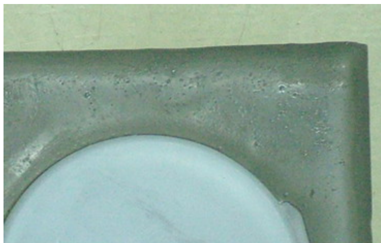
ภาพที่ 112 ผลงานจาก platen ยางพาราทำกับชิ้นงานพลาสติก PS โดยใช้อิพอกซีเรซินเติมอลูมิเนียม เทหล่อหนา 5 มิลลิเมตร
