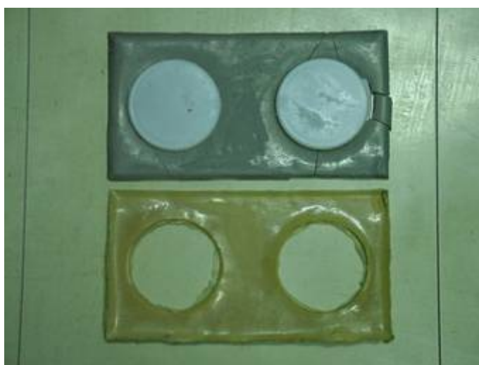
ภาพที่ 111 งาน platen ยางพารากับชิ้นงานพลาสติก PS และงานหล่อที่ได้
