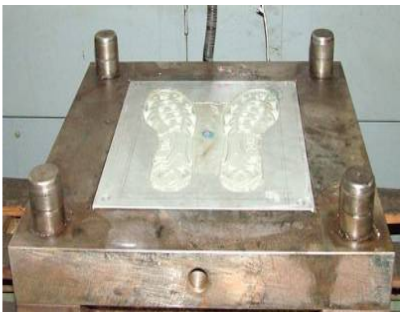
ภาพที่ 129 ประกอบอินเสิร์ตแม่พิมพ์ฉีดยางที่หล่อได้กับพิมพ์แผ่นคอร์
