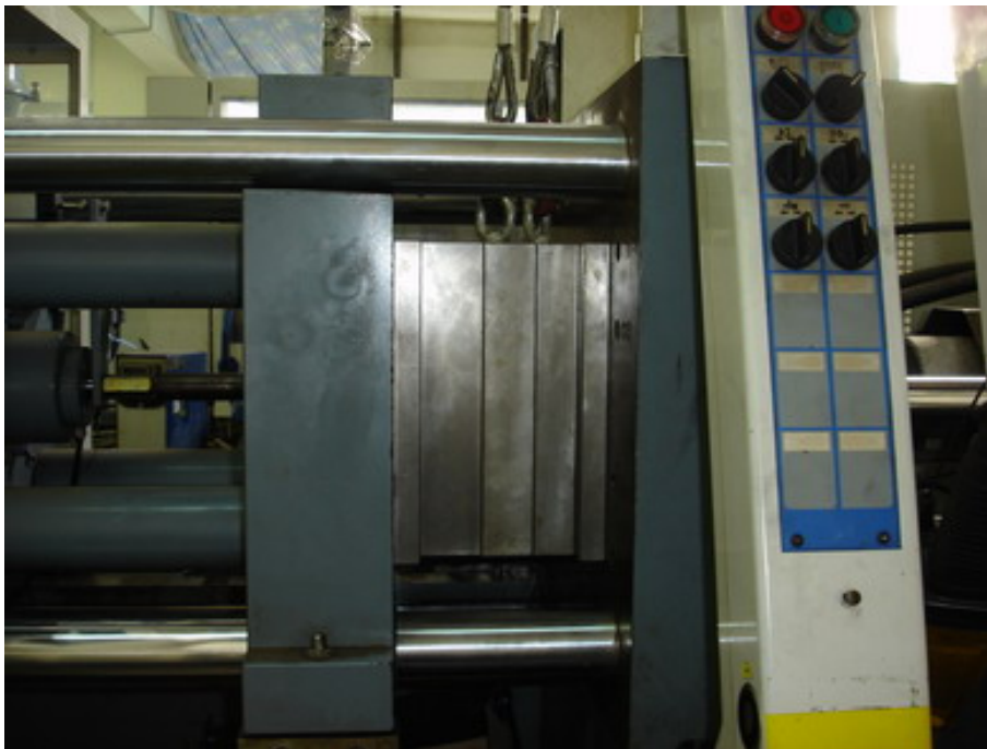
ภาพที่ 71 ปิดแม่พิมพ์เข้ากับเครื่องฉีดพลาสติกที่แรงดันสูง (High pressure)
