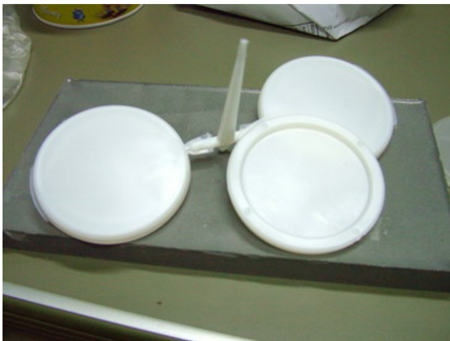
ภาพที่ 77 ชิ้นงานพลาสติกโพลีสไตรีน (Polystyrene, PS) ที่ฉีดขึ้นรูป
