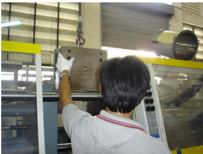
ภาพที่ 70 เคลื่อนย้ายแม่พิมพ์เข้าเครื่องฉีดพลาสติก
