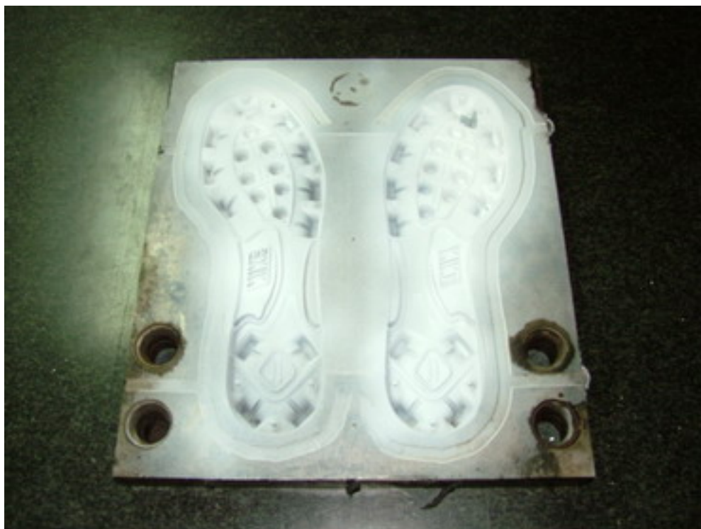
ภาพที่ 79 อินเสิร์ทแม่พิมพ์ฉีดยาง รองเท้า NIKE ฟันสเปร์ย์แปรงเคลือบผิว
