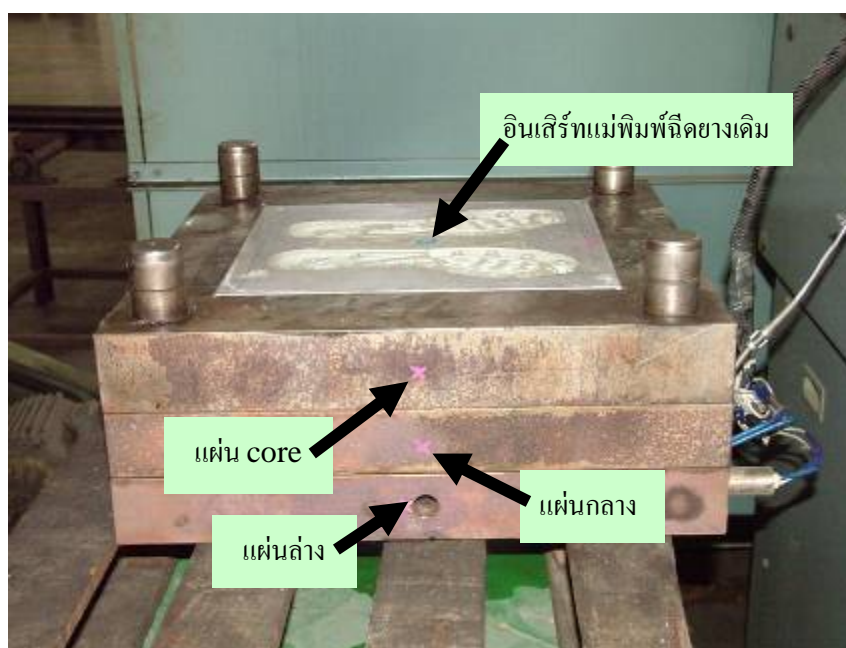
ภาพที่ 136 แม่พิมพ์ฉีดยางพร้อมอินเสิร์ทแม่พิมพ์ที่ทำการหล่อขึ้นที่ประกอบด้วยแท่งนำความร้อนเพื่อวัดอุณหภูมิ
