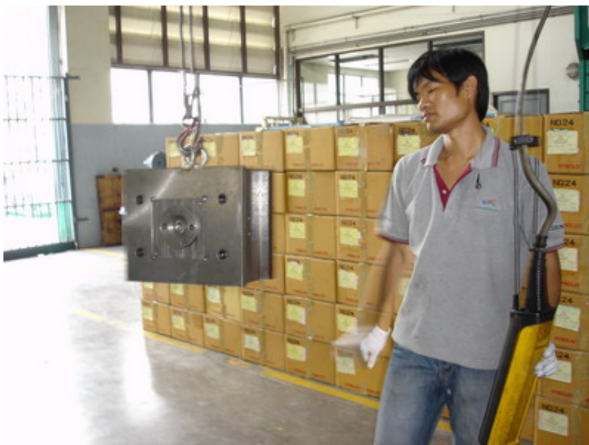
ภาพที่ 69 ประกอบแม่พิมพ์เรียบร้อย เตรียมขึ้นเครื่องฉีดพลาสติก
