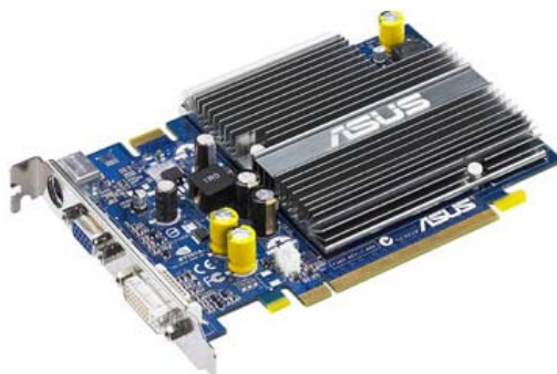
ภาพที่ 9 การ์ดแสดงผลยี่ห้อ Asus รุ่น EN7600GS SILENT/HTD Series ที่มา: บริษัท เอเชีย เทคโนโลยี อินเทอร์เน็ต (2006)
