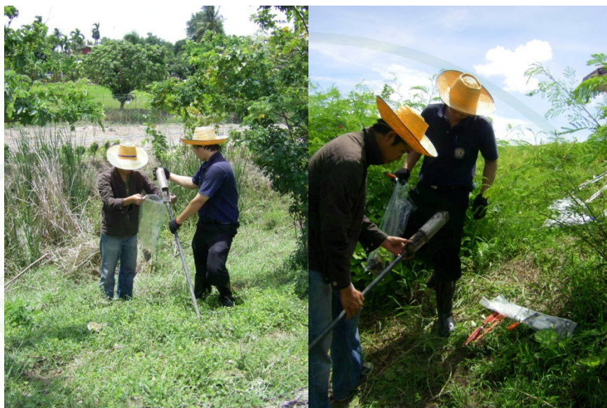
ภาพที่ 41 การเก็บตัวอย่างดินโดยสว่านมือ (Hand Auger) ในพื้นที่ที่ทำการศึกษา
