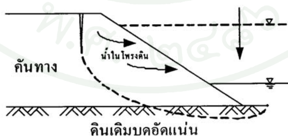
ภาพที่ 36 การเกิดรอยแตกที่ขอบผิวทางในถนนลาดยางเมื่อเกิดการลดระดับของน้ำข้างทาง
