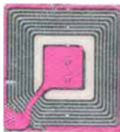
ภาพที่ 4 Tags ของระบบ EAS จะมีเฉพาะเสาอากาศอย่างเดียว
