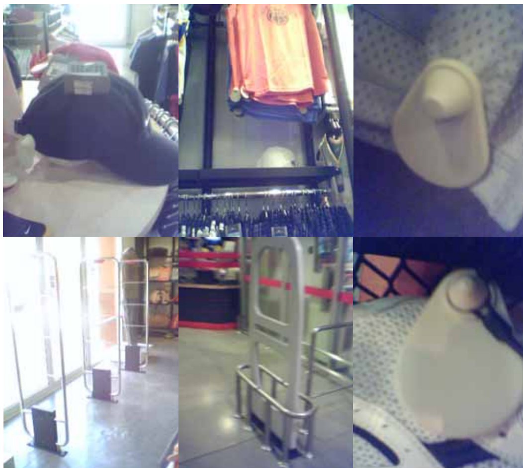
ภาพที่ 6 สินค้าที่ติด Key Tags เพื่อป้องกันการขโมยและเสาะอากาศของระบบ EAS
