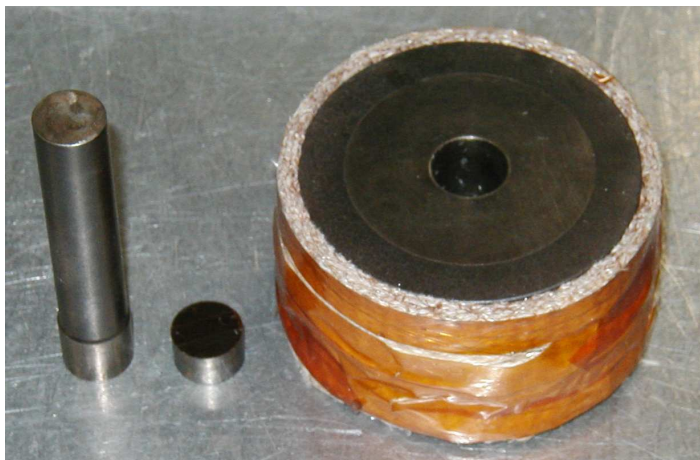
ภาพที่ 33 อุปกรณ์ที่ใช้ในการให้ความดันระหว่างการบ่มตัวอย่าง
