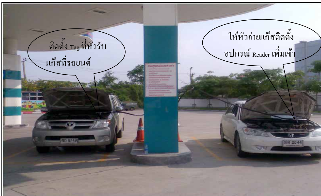
ภาพที่ 17 แสดงการติดตั้งหัวอ่านที่หัวจ่ายแก๊ส
