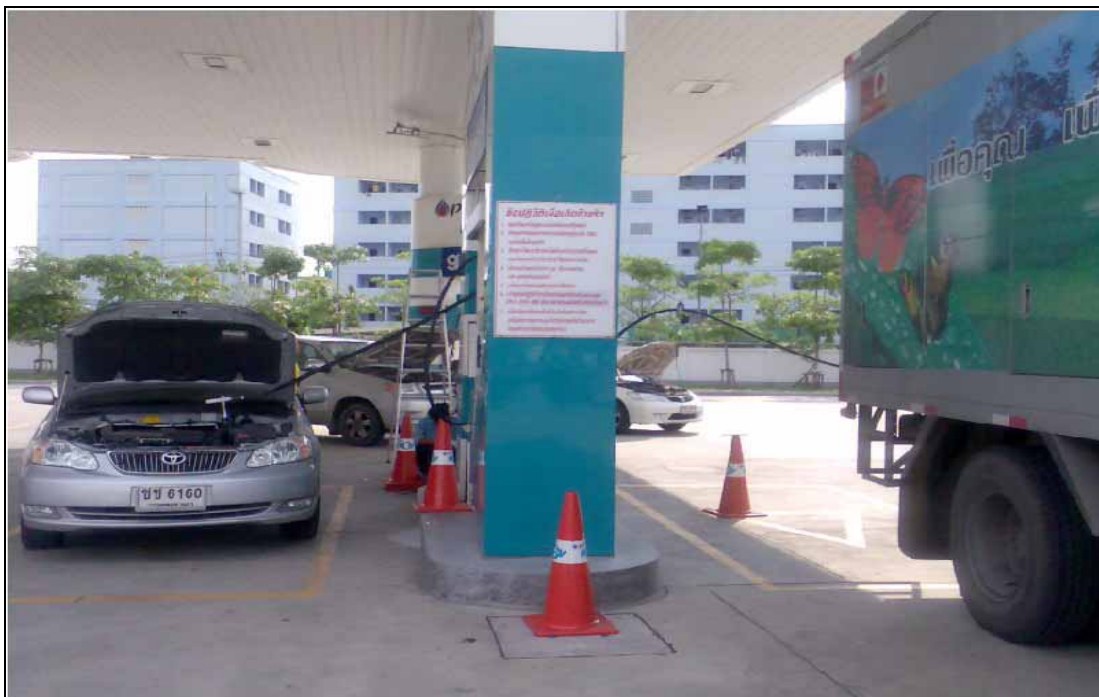
ภาพที่ 14 การทดลองจอตเติมแก๊สในตำแหน่งต่างๆ
