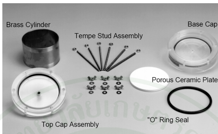
ภาพที่ 27 อุปกรณ์การทดสอบอัตราการเติมน้ำ (Imbibition rate test) (Soil moisture equipment)
