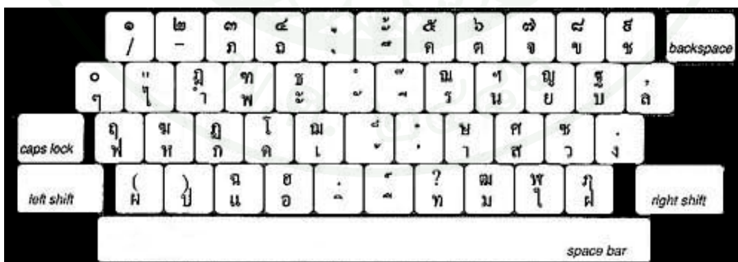
ภาพที่ 2.3 แป้นอักษรแบบเกษมณี ที่มา: Thaweesak Koanantakool (1993)
