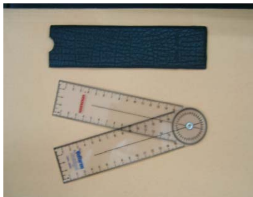
ภาพผนวก 2 เครื่องมือวัดมุมการเคลื่อนไหว Goniometer
