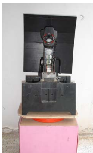
เครื่องยิงลูกเทเบิลเทนนิสและแท่นปรับทิศทางการปล่อยลูก
