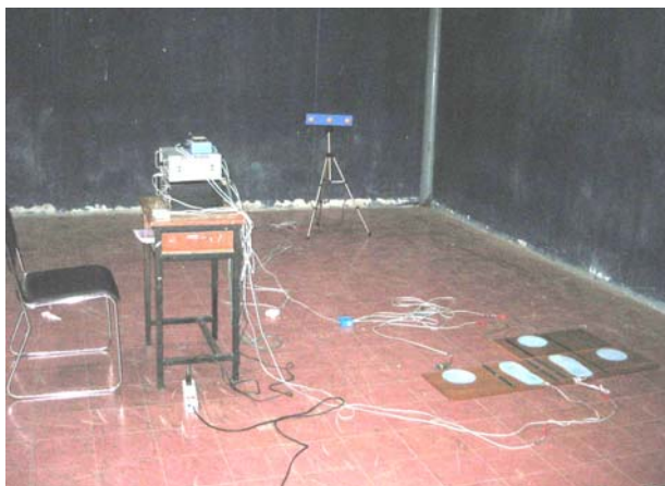
เครื่องวัดเวลาปฏิกิริยาตอบสนองของตา กับเท้า และเวลาปฏิกิริยา
