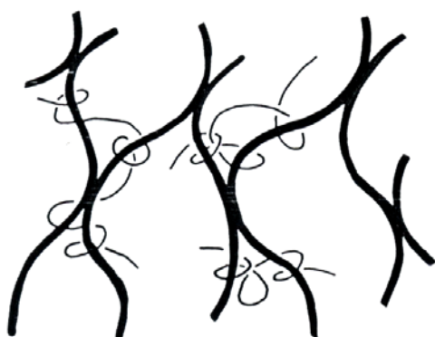
ภาพที่ 9 โครงสร้างการเกิดเจลผสมแบบที่ 1
