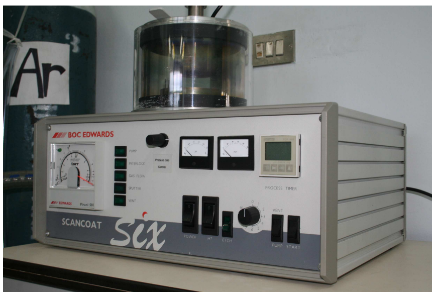
ภาพที่ 21 เครื่องเคลือบฟิล์มด้วยวิธีดีซี-สปัตเตอร์ริง รุ่น Scancoat Six Sputter Coater
