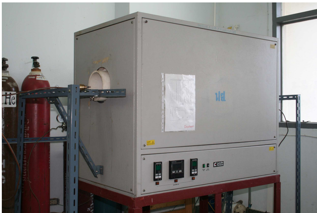
ภาพที่ 23 เตาเผา ชนิด 2 โซน จอแสดงผลแบบ LCD ความต่างศักย์ 220 โวลต์ 50 เฮิร์ตซ์
