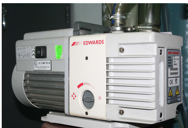
ภาพที่ 22 เครื่องสูบลูญากาศโรตารี (rotary vacuum pump) รุ่น RV3
