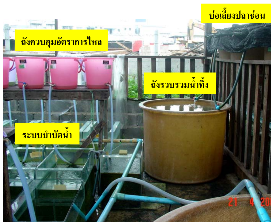
ภาพที่ 2 ภาพจำลองระบบบำบัดน้ำ
