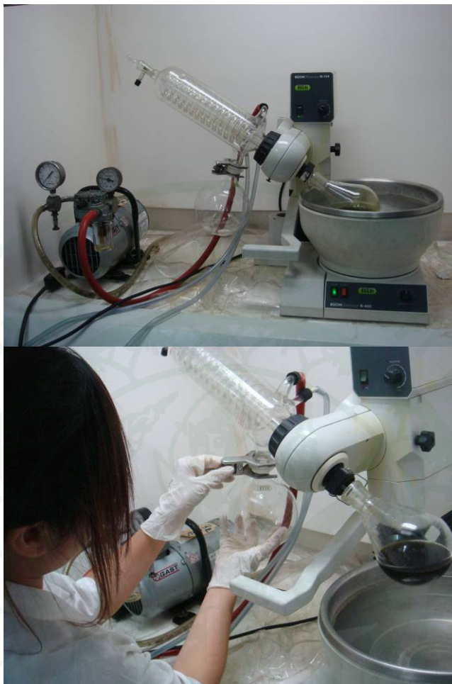
ภาพที่ 26 แสดงการระเหยตัวทำละลายออกโดยใช้เครื่อง Rotary evaporator
