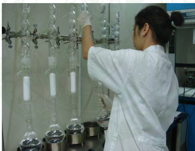
ภาพที่ 25 แสดงการสกัดสารโดยใช้ Soxhlet's extractor
