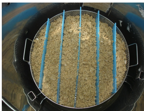
ภาพที่ 9 ลักษณะการวางแผ่นพลาสติก 5 แผ่นกั้นแบ่งวัสดุหมักตามแนวเส้นผ่านศูนย์กลาง
