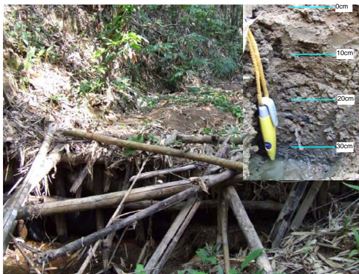
ภาพที่ 23 ระดับความสูงของตะกอนหน้าฝายชะลอการไหลของน้ำท่า และบริเวณลำห้วยป่าสาว อำเภอสังขละบุรี จังหวัดกาญจนบุรี ในเดือนกุมภาพันธ์ 2549
