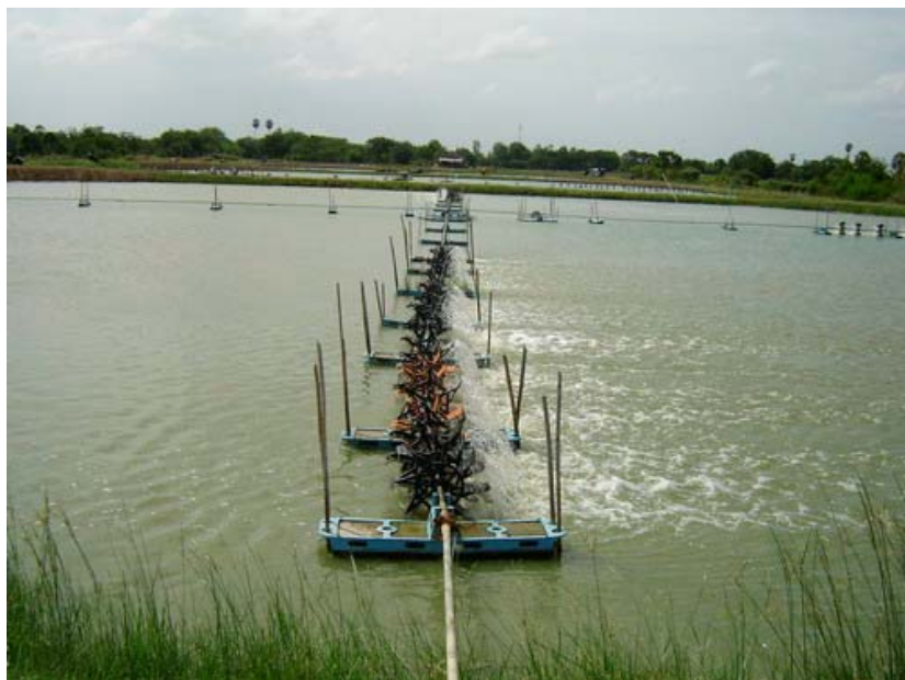
ภาพผนวกที่ 10 การวางเครื่องให้อากาศของบ่อทดลอง จ.ราชบุรี
