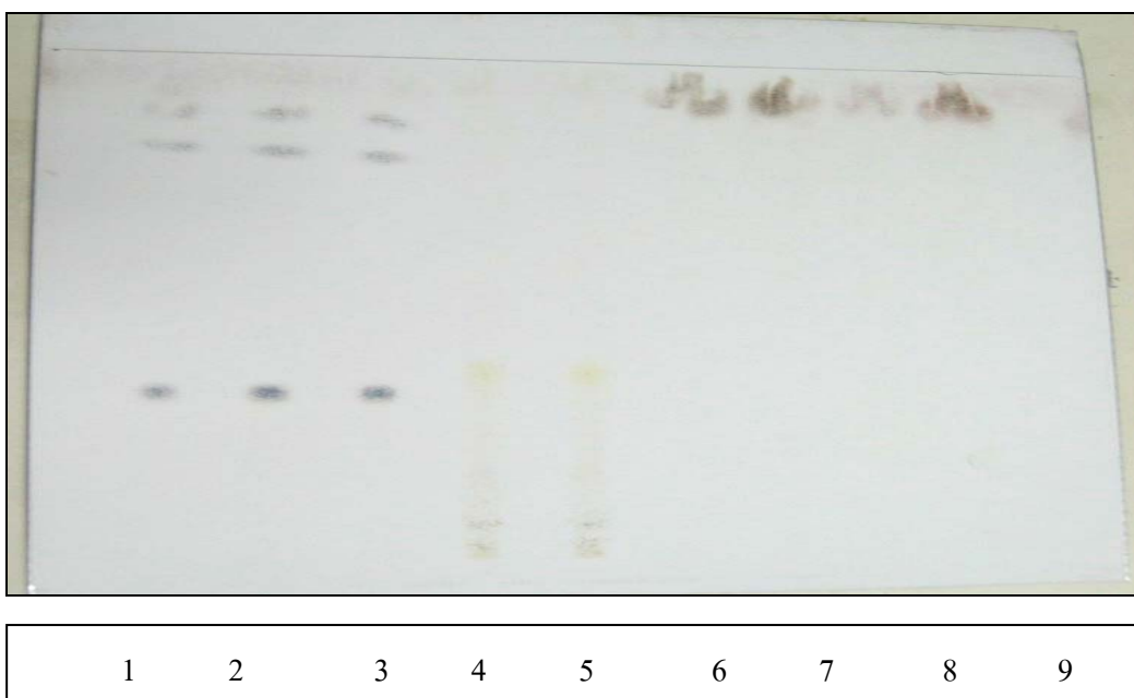
ภาพที่ 11 TLC fingerprints โดยแถวที่ 1-3: สารมาตรฐานผสม (เอเชียติโคไซด์ กรดมาเดคาสสิก และกรดเอเชียติก) ความเข้มข้น 1000 ppm (20 \mu l) แถวที่ 4-5: สารสกัดน้ำ (20 \mu l) แถวที่ 6-7: สารสกัด ปีโตรเลียมอีเทอร์ (20 \mu l) แถวที่ 8-9: สารสกัดเฮกเซน (20 \mu l)
