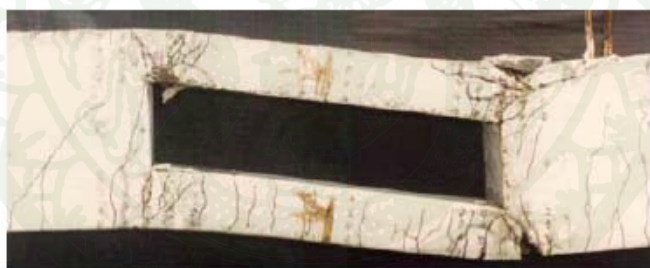
ภาพที่ 6 การวิบัติภายใต้แรงดัด และแรงเฉือน
