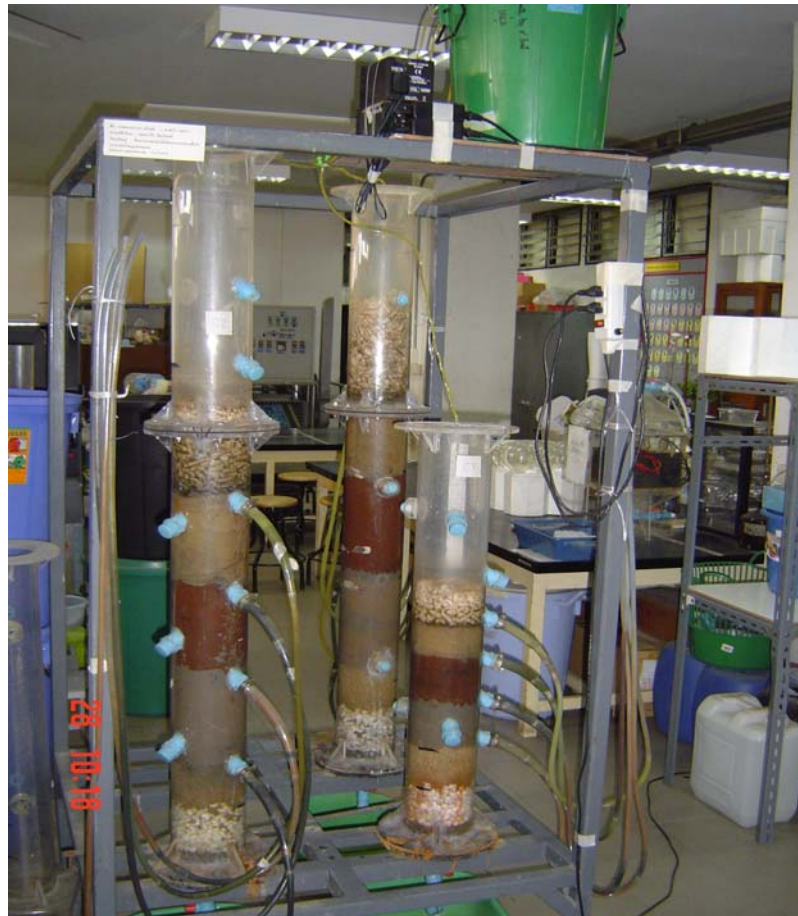
ภาพผนวกที่ ก3 คอลัมน์จำลองระบบดินและหินเรียงเป็นชั้น
