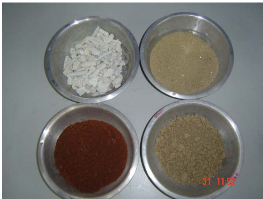
ภาพผนวกที่ ก1 ตัวอย่างวัสดุ หินปูน ทราย ดินเหนียว และดินเหนียวปนตะกอน
