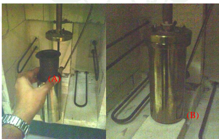
ภาพที่ 9 ภาพขณะบรรจุถ่านหิน (A) เครื่องปฏิกรณ์ (B) สำหรับทดลองการลุกไหม้ได้เองของถ่านหิน
