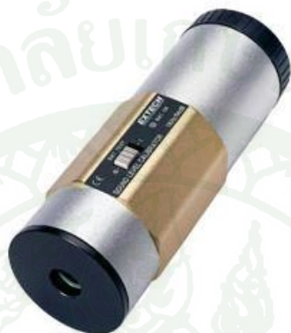
ภาพที่ 5 เครื่องปรับค่า (Calibrator) สำหรับเครื่องวัดเสียง
