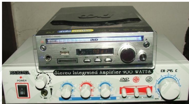
ภาพที่ 24 ชุดเครื่องกำเนิดความถี่เสียง ประกอบด้วยเครื่องเล่น DVD และเครื่องขยายเสียง
