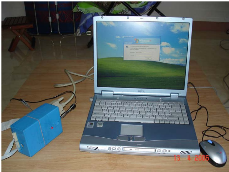
ภาพผนวกที่ ๑1 ชุดคอมพิวเตอร์ และ โปรแกรมควบคุมเครื่องวัดปฏิบัติการตอบสนอง (SUKIVE I)
