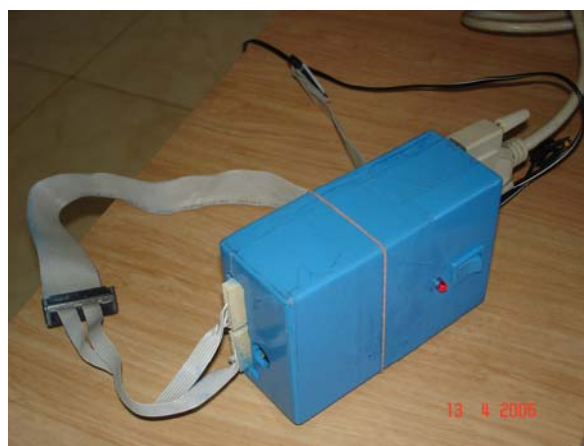
ภาพผนวกที่ ๑3 กล่องควบคุมแปลงสัญญาณดิจิทัล และจุดรับส่งสัญญาณไปที่เป้า
