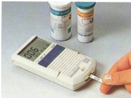
ภาพผนวกที่ ข1 การปริมาณกรดแลคติกด้วยเครื่อง Accutrend Lactate ประเทศเยอรมนี
