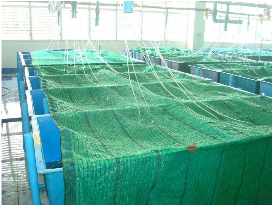
ภาพที่ 1 ถังไฟเบอร์กลาสขนาดความจุ 500 ลิตร ที่ใช้ในการทดลองเลี้ยงกุ้งขาวแวนนาไม ในห้องปฏิบัติการ
