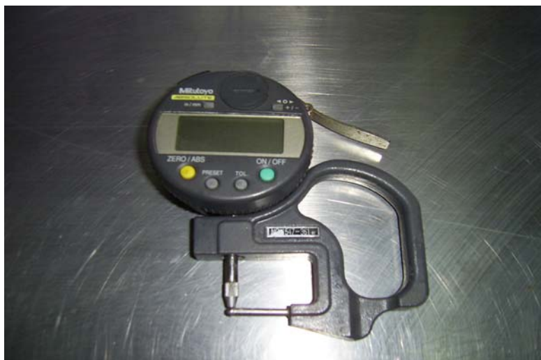
ภาพผนวกที่ 6 เครื่องไมโครมิเตอร์สำหรับวัดความหนาเปลือกไข่
