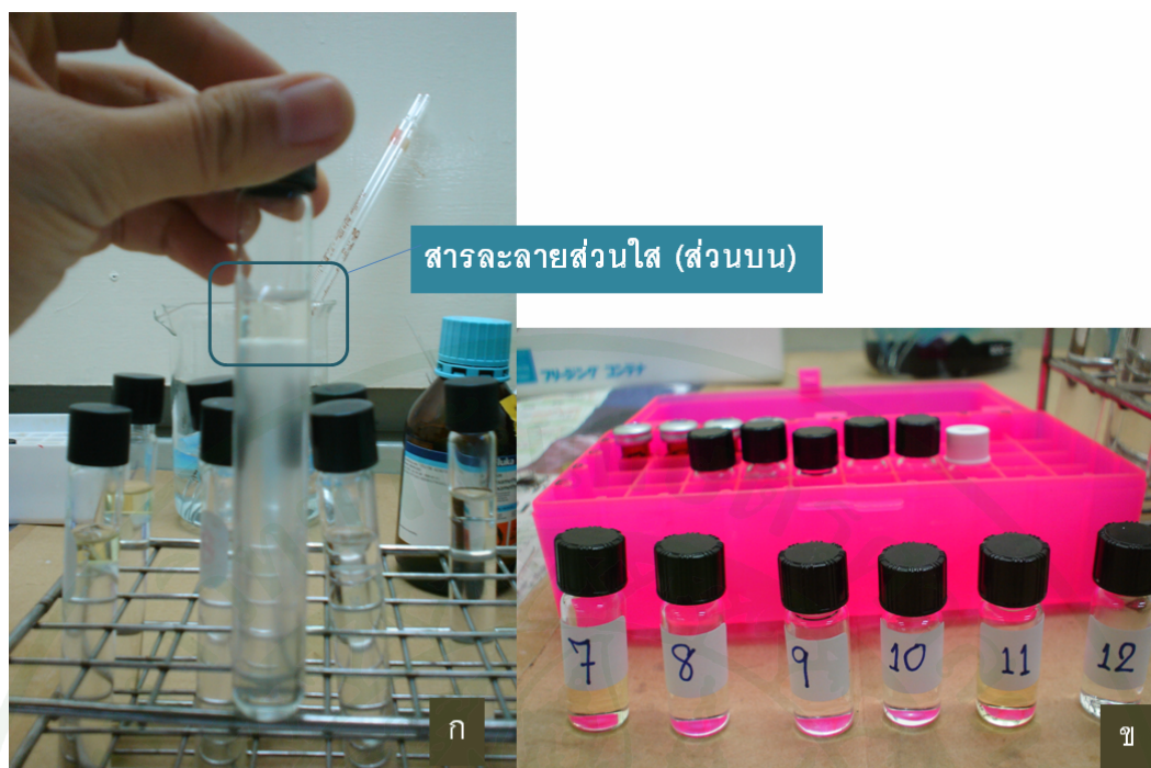
ภาพผนวกที่ 10 สารละลายส่วนใสด้านบนหลังจากเติมน้ำกลั่น และเขย่าอย่างแรง (ก) การเก็บสารละลายตัวอย่างเพื่อวิเคราะห์ปริมาณคอเลสเตอรอลด้วยเครื่อง gas chromatography (ข)
