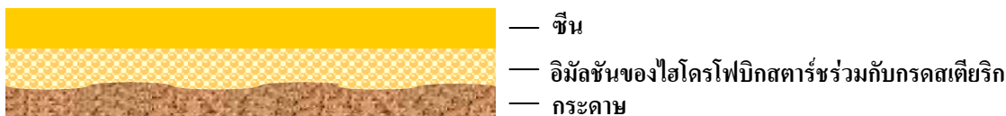
ภาพที่ 11 แสดงลักษณะสารเคลือบผสมระหว่างไฮโดรโฟบิกสตาร์ร่วมกับกรดไขมันสเตียริก และการเคลือบสารละลายขึ้นเป็นชั้นที่สองบนกระดาษแข็ง
