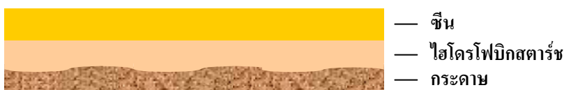
ภาพที่ 10 แสดงลักษณะสารเคลือบไฮโดรโฟบิกสตาร์ชร่วมกับการเคลือบสารละลายซินเป็นชั้นที่สองบนกระดาษแข็ง
