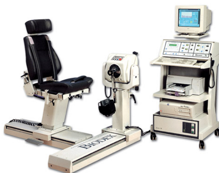
ภาพผนวกที่ 4 เครื่องมือการทดสอบไอโซไคเนติก ไดนาโมมิเตอร์
