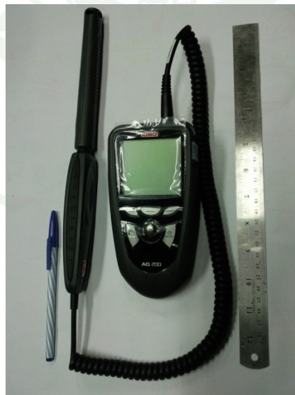
ภาพที่ 7 เครื่องมือวิเคราะห์ก๊าซคาร์บอนไดออกไซด์ภาคสนาม KIMO AQ 200
