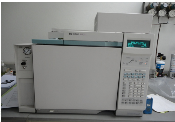
ภาพที่ 12 เครื่อง Gas Chromatography เพื่อวิเคราะห์สารที่มีซัลเฟอร์เป็นส่วนประกอบ ส่วนประกอบ Flame Photometric Detector (FPD)
