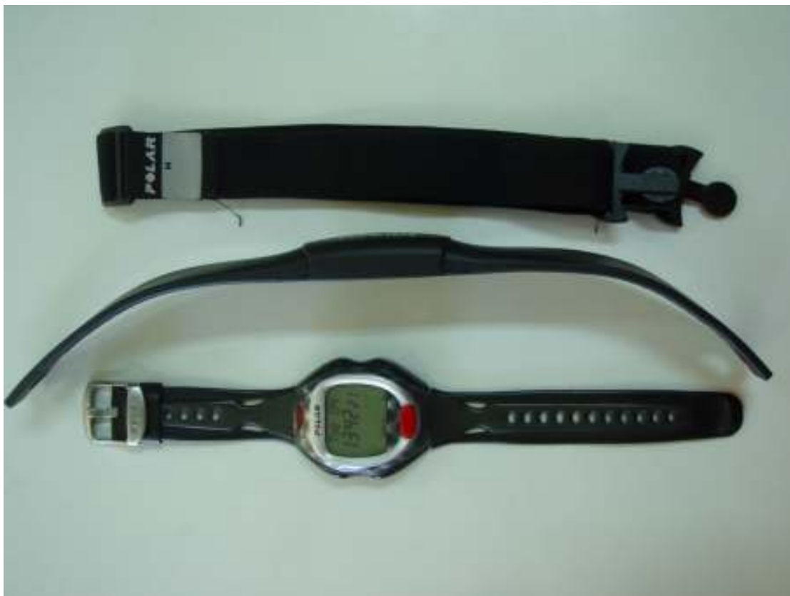
ภาพผนวกที่ น3 ภาพเครื่องบันทึกอัตราการเต้นของหัวใจแบบไร้สายยี่ห้อ Polar รุ่น Sport Tester ผลิตในประเทศฟินแลนด์
