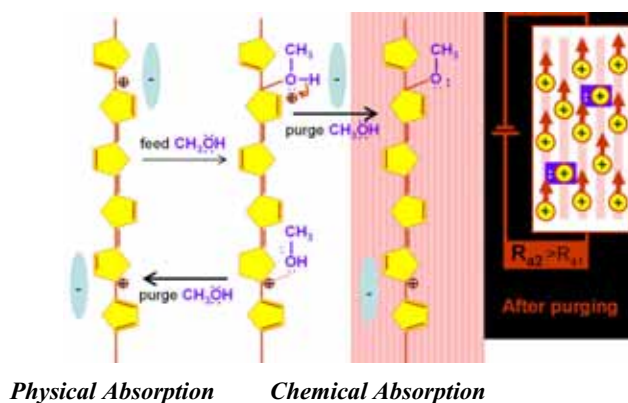
ภาพที่ 23 การเกิด Physical และ Chemical Absorption ของโมเลกุลก๊าซบนผิวของพอลิไพร์โรล
