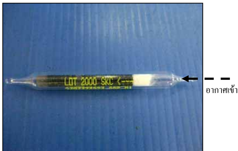
ภาพที่ 13 ทิศทางการดูดอากาศเข้า Charcoal Tube
