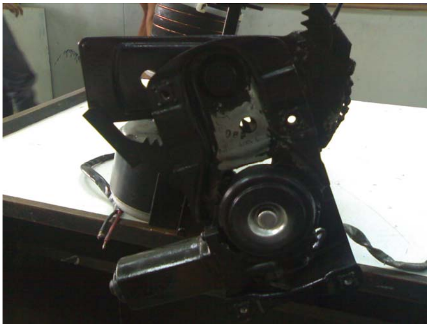
รูป 45 การเชื่อมต่อระหว่างมอเตอร์ยกรจากกับมอเตอร์ที่ใช้ส่งลูก
