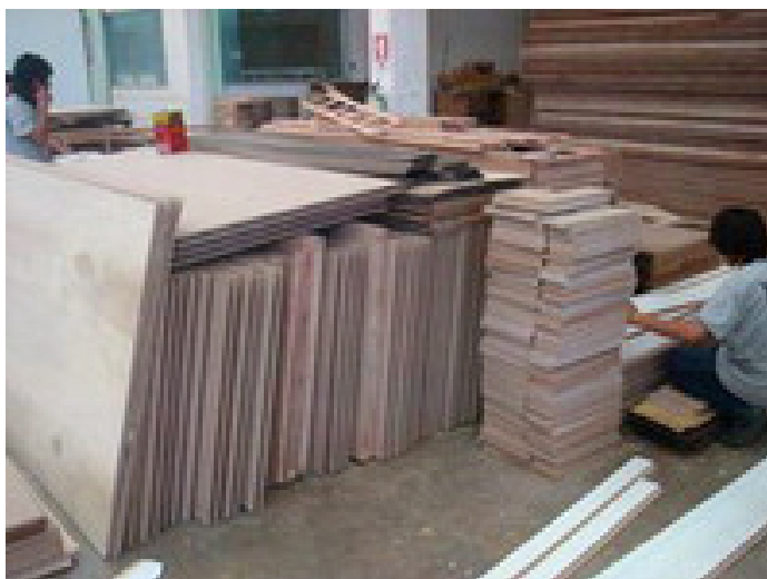
ภาพที่ 17 การเตรียมงานตัวปะขอบไม้ หรือ แผงบังไฟ (หลอดไฟภายในตู้)
