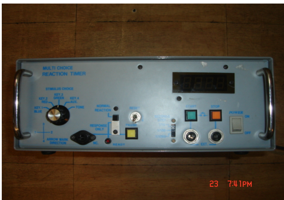
ภาพผนวกที่ ๑2 เครื่องจับเวลา (Electronic timer) แสดงทศนิยม 3 ตำแหน่ง มีหน่วยเป็นวินาที
