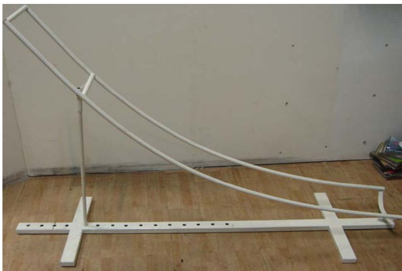
ภาพผนวกที่ ๑1 รางสำหรับกึ่งลูกบอลขนาด 12 นิ้ว x 1.2 m. x 1.5 m. ใช้สำหรับกึ่งลูกบอลในการฝึกทักษะแบบฝึกที่ 3 (รับบอล) เพื่อควบคุมทิศทางและความเร็วของลูกบอลให้สม่ำเสมอ
