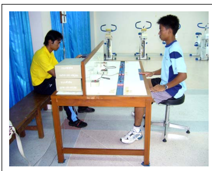
ภาพผนวกที่ ๑1 เครื่องมือทดสอบเวลาปฏิกิริยาตอบสนองของตากับมือ
