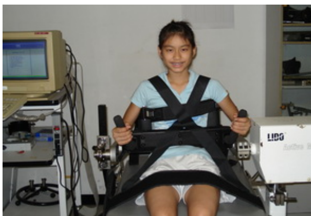
ภาพผนวกที่ ง3 การทดสอบความแข็งแรงของกล้ามเนื้อหลังด้วยเครื่องไอโซโคเนติก ไดนาโมมิเตอร์ ยี่ห้อ Lido multi joint II
