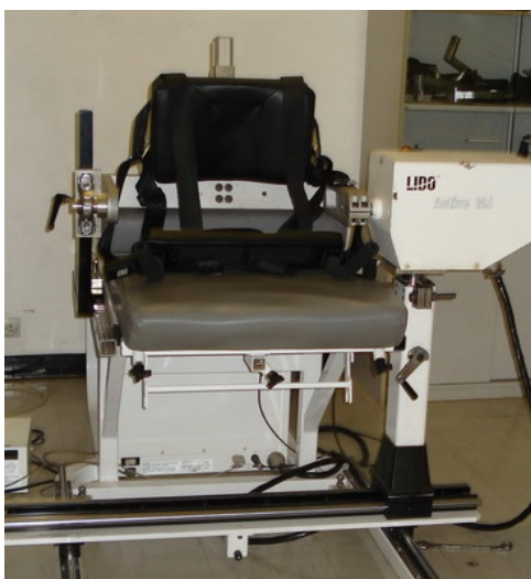
ภาพผนวกที่ ง2 ชุดทดสอบ ประกอบไปด้วย เบาะนั่งหรือนอน พร้อมตัวหน่วยแรงที่สามารถปรับเปลี่ยนวิธีการทดสอบ
