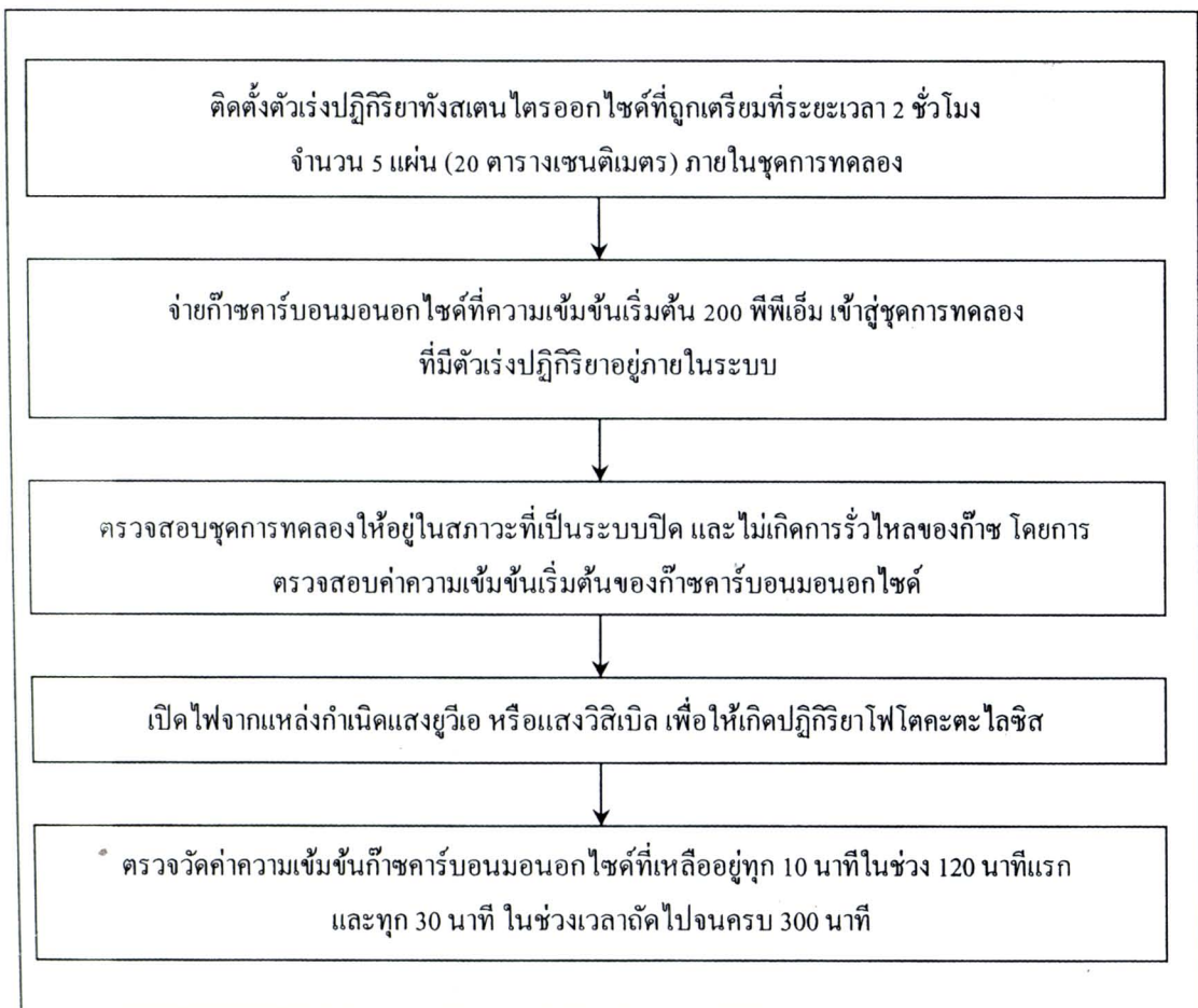
รูปที่ 3.8 ขั้นตอนวิธีการศึกษาผลของแหล่งกำเนิดแสงที่มีต่อการบำบัดก๊าซคาร์บอนมอนอกไซด์ด้วย ปฏิกิริยาโฟโตคะตะไลซิส
