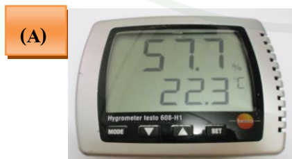
ภาพที่ 9 เครื่องวัดความชื้นสัมพัทธ์และอุณหภูมิสิ่งแวดล้อม (A) เครื่องมือวัดอุณหภูมิทวารหนัก (B)
