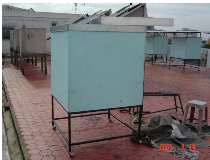
ภาพที่ 72 แสดงท่อนำแสงแบบรูปทรงกระบอกพื้นที่หน้าตัดสี่เหลี่ยมจัตุรัสต่อกับกล่องทดลองด้วยท่อปลายตัด
