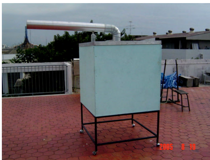
ภาพที่ 69 แสดงท่อนำแสงแบบท่อกลมที่ใช้ในการทดลองเรื่องทิศทางของการหันท่อนำแสง
