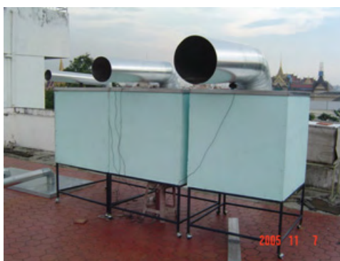
ภาพที่ 78 แสดงท่อนำแสงแบบท่อกกลมที่ใช้ในการทดลองเรื่องขนาดท่อนำแสง
