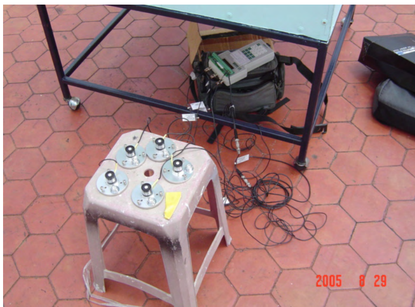
ภาพที่ 68 แสดงหัววัดแสงที่ใช้ในการทดสอบ
