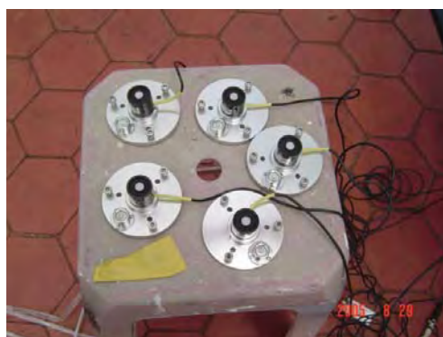
ภาพที่ 53 หัววัดแสงสำหรับต่อกับเครื่องวัดความส่องสว่าง ดาต้าล็อกเกอร์ รุ่น LI-1400
