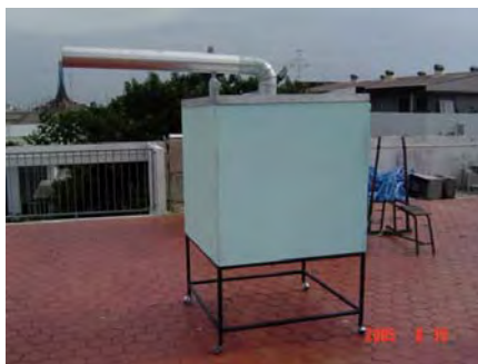
ภาพที่ 58 แสดงกล่องทดลองขณะประกอบเข้ากับท่อนำแสง
