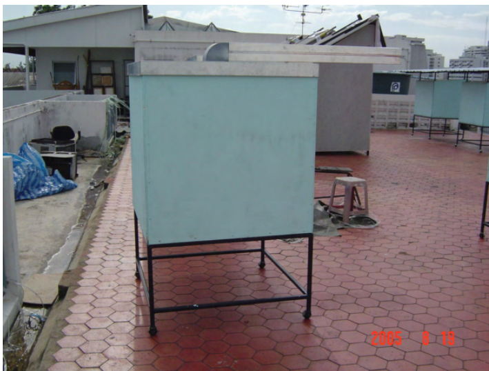
ภาพที่ 71 แสดงท่อนำแสงแบบรูปทรงกระบอกพื้นที่หน้าตัดสี่เหลี่ยมจัตุรัสต่อกับกล่องลงด้วยท่อโค้ง
