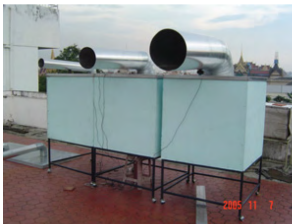
ภาพที่ 67 แสดงท่อนำแสงแบบท่อกกลมที่ใช้ในการทดลองเรื่องขนาดท่อนำแสง
