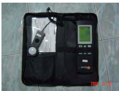
ภาพที่ 51 เครื่องวัดความส่องสว่าง (Lux Meter) รุ่น Testo 545
