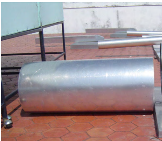
ภาพที่ 57 อลูมิเนียมที่ใช้ในการทำท่อนำแสงในการทดลอง
