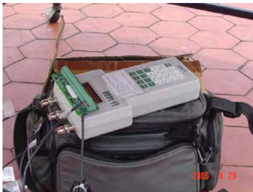
ภาพที่ 52 เครื่องวัดความส่องสว่าง ดาต้าล็อกเกอร์ รุ่น LI-1400
