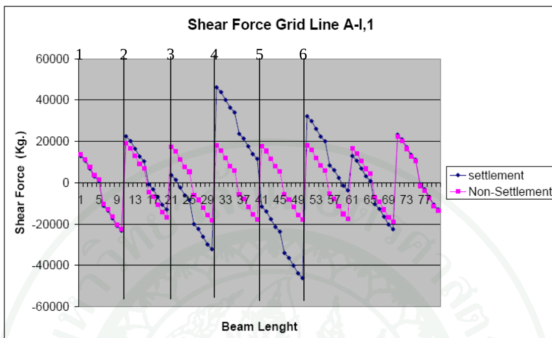
ภาพที่ 71 การเปรียบเทียบแรงเฉือนก่อนและหลังการทรุดตัวที่ตำแหน่งที่ 1 แนวคานที่ 1
