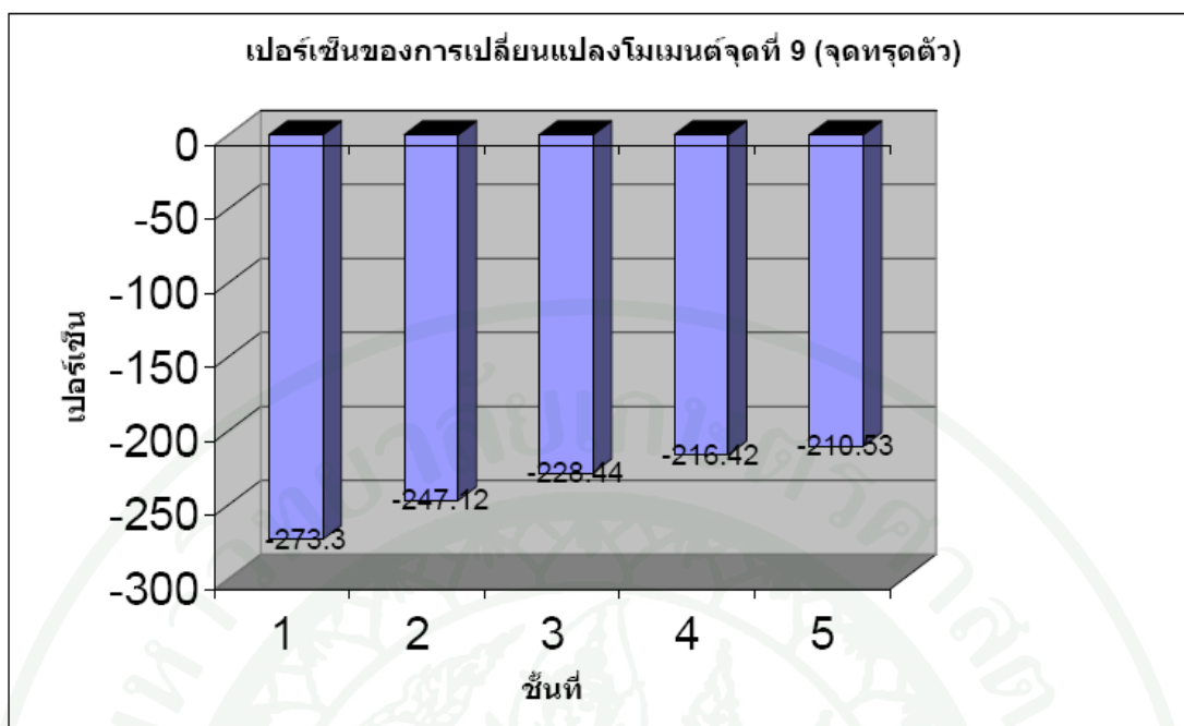
ภาพที่ 87 เปอร์เซ็นต์การเปลี่ยนแปลงโมเมนต์ในแต่ละชั้นของจุดที่เกิดการทรุดตัวของคานในตำแหน่งที่ 6
