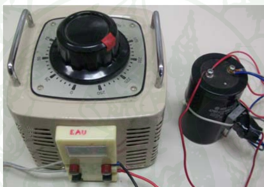
ภาพที่ 51 วงจรเรียงกระแสเต็มคลื่นแบบบริดจ์ชนิดไดโอด (0-30 V dc )
