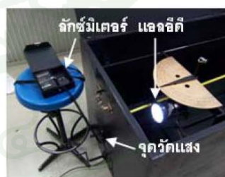
รูปที่ 4 การวัดค่าความสว่างจากกล่องวัดแสง (ภาพการทดลองจริง)
