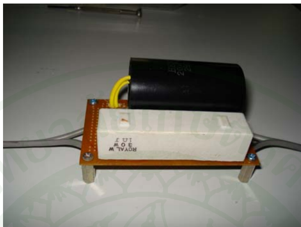
ภาพที่ 55 R-C filter ที่ประกอบด้วยตัวต้านทาน 1\ \Omega , ตัวเก็บประจุ 20\ \mu F
