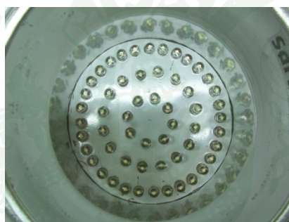
ภาพที่ 47 หลอดไฟฟ้าจากแอลอีดีที่บรรจุในโคมดาวน์ไลท์จำนวน 3 แถว รวม 56 หลอด
