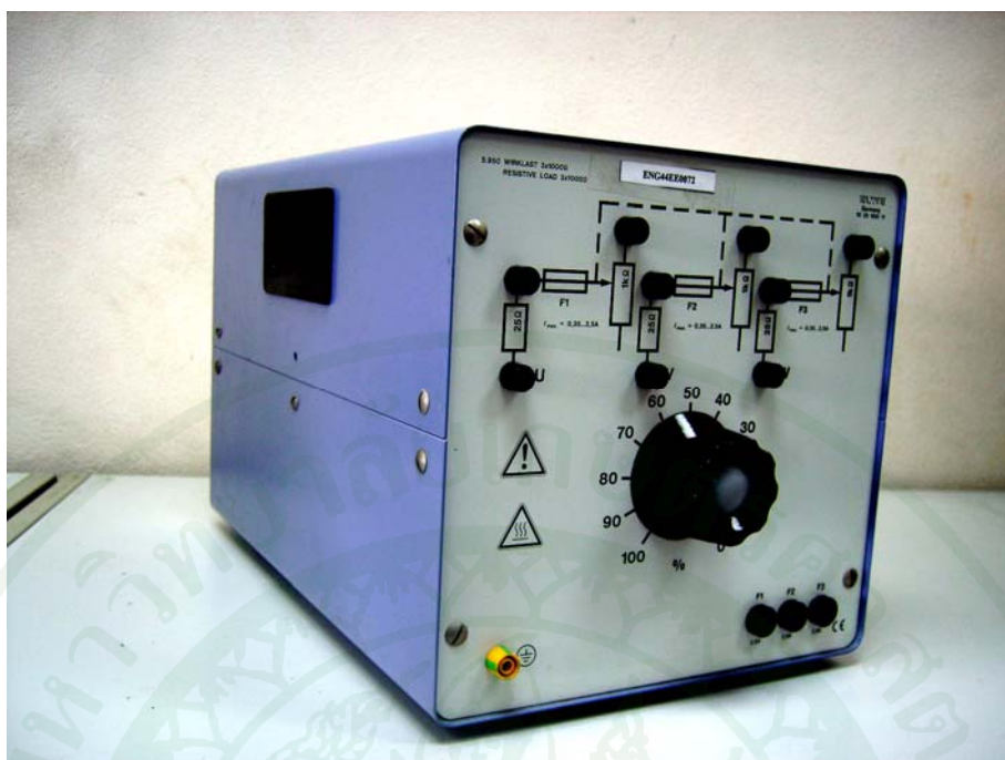
ภาพผนวกที่ 1 ความต้านทานโหลดที่ใช้ในการทดลองเทียบกับแอลอีดี
